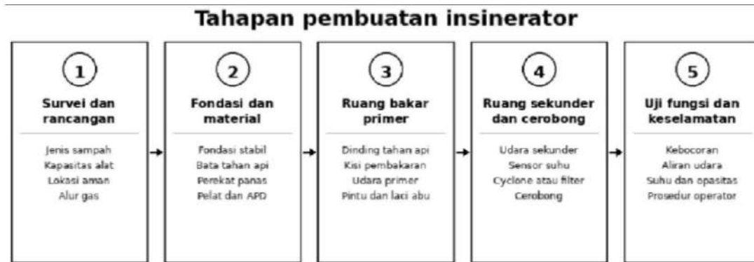
Gambar 3. Tahapan pembuatan insinerator berdasarkan sintesis literatur
