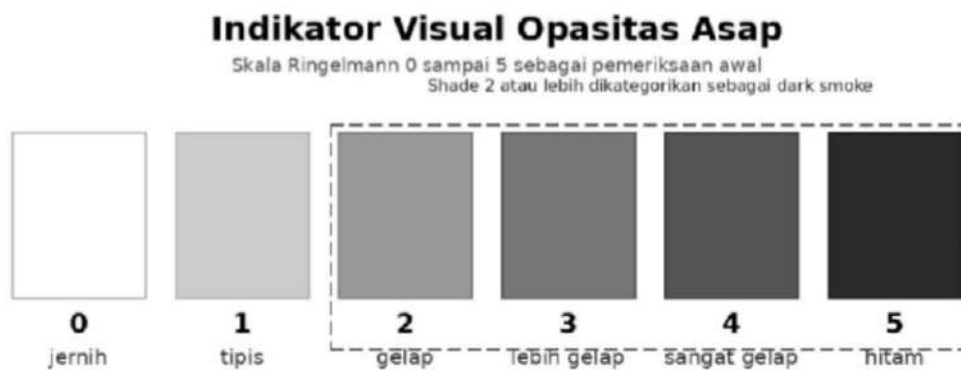
Gambar 1. Indikator sederhana opasitas asap yang digambar ulang berdasarkan U.S. EPA Method 9 dan pedoman Ringelmann
