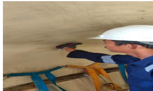
Gambar 1. Keadaan Dinding Bagian Dalam Sekoci Berjamur
