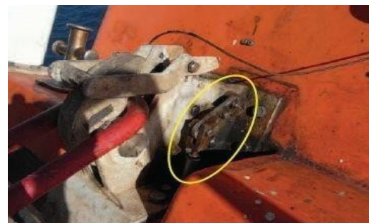
Gambar 2. Kerusakan pada baut realese hook
